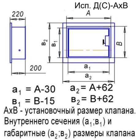
Рис.1. Установочные, габаритные и размеры внутреннего сечения клапана.
